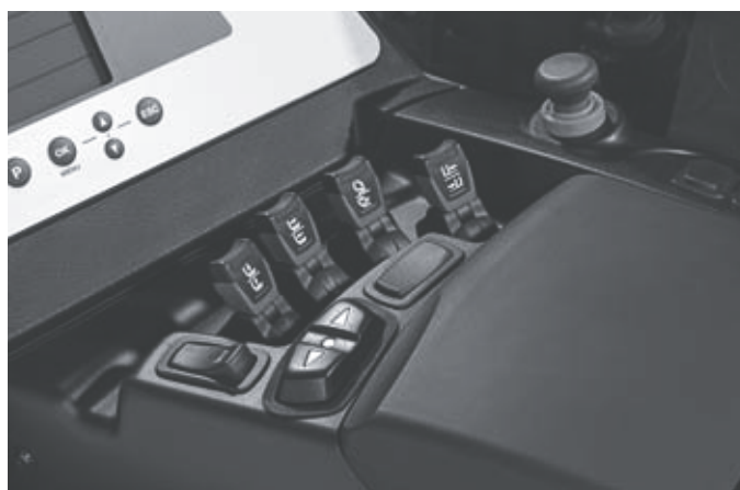
Простое управление всеми функциями, без перехвата, с помощью Fingertip
